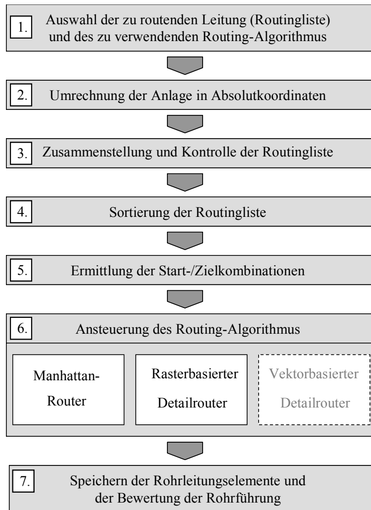
Abbildung 5-14: Schematische Darstellung der Rohrleitungsgenerierung
