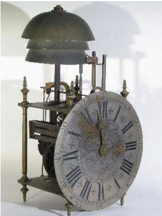
Bild 126: Beispiel für eine eiserne Räderuhr aus dem 18. Jahrhundert: Französische Laternenuhr ca. 1720 (Wehrle 2003)
