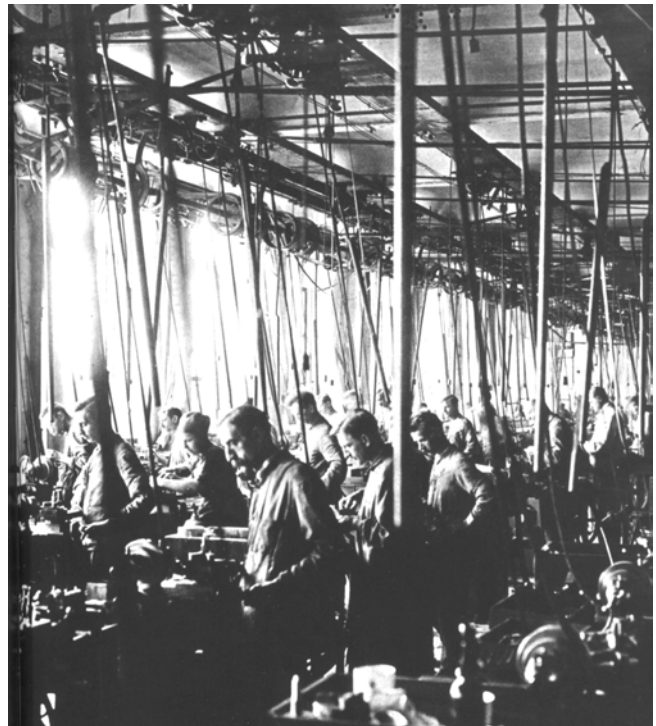
Bild 175: Blick in die Werkstatt für die Massenfertigung von Telefonen-Geräten bei Siemens&Halske in Berlin. Fotografie um 1900 (Brandstätter/Hubmann 1977, o. P.)
