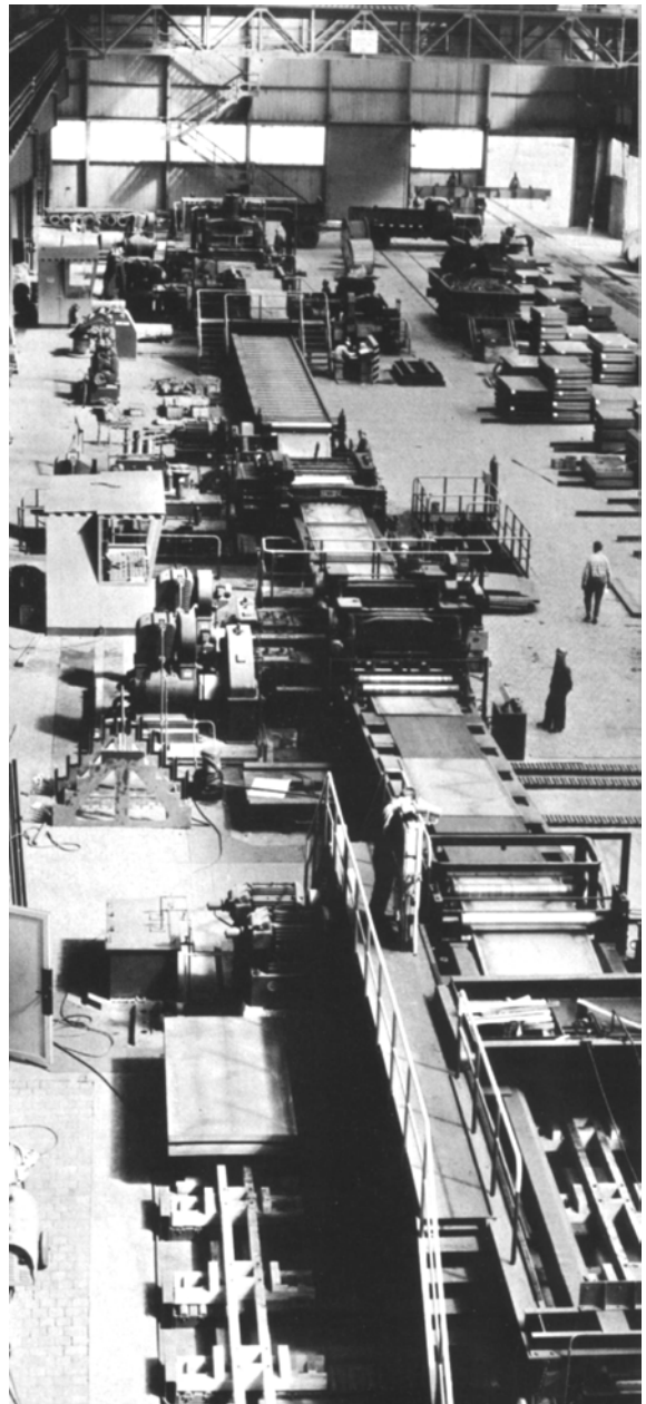
Bild 190: Vollautomatische Bandzerteilanlage zum Zuschnitt von Walzblech. Fotografie 1960 (Cube 1964, 53)
