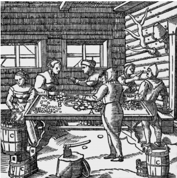
Bild 96: Frauen beim Erzklauben (Trennen des Erzes vom tauben Gestein) an der „Klaubetafel“ (A). GEORGIUS AGRICOLA bemerkt dazu: „Wenn aber die Berghäuer [...] das Erz mit Erde und Stein vermengt haben, so klauben nicht allein Männer das Erz, sondern auch Jungen und Weiber.“ Holzchnitt 1556 (Agricola 2003, 231 f.)
