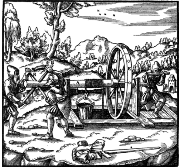
Bild 108: Energiequelle Mensch als Antrieb für die Haspelwinde. AGRICOLA schreibt dazu: „Wenn drei Haspler diese Maschine im Kreise drehen, dann sind an dem einen Ende des Rundbaumes vier Stäbe durchgesteckt, am anderen Ende befindet sich jenes Haspelhorn, das in den Bergwerken allein angewendet wird. [...] Das Haspelhorn dreht ein Mann, die gekreuzten Stäbe zwei, von denen der eine zieht, der andere drückt. Alle Haspler, an welcher Maschine sie auch arbeiten, müssen starke Leute sein, damit sie eine so schwere Arbeit leisten können.“ Holzchnitt 1556 (Agricola 2003, 132)
