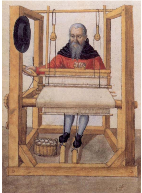
Bild 115: Typisches Heimgewerbe im Verlag: Leineweber an einem Trittwebstuhl. Mit den Füßen bedient er die Schäfte zum Heben und Senken der Kettenfäden, in der rechten Hand hält er das Schiffchen mit dem Schussfaden und mit der linken bedient er die Lade, die die Fäden zusammenschiebt. Anonyme Federzeichnung 1610 (Roeck 2000, 26)
