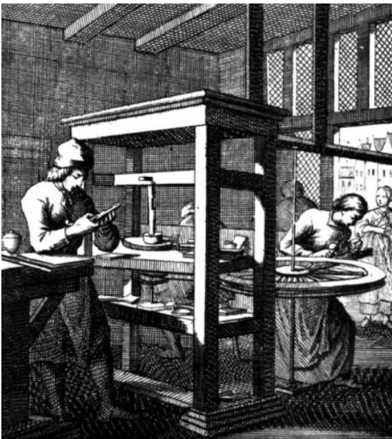
Bild 120: Edelsteine schleifen oder Gerätschaften aus einem Stück Stein schneiden, „diejenige, so in dieser Kunst erfahrene / nennet man die Edelgestein-Schneider.“ Der Frau fällt hier der körperlich anstrengendere Part zu, sie bedient den Antrieb für die Schleifmaschine. Kupferstich 1698 (Weigel 1987, 268, 270a)
