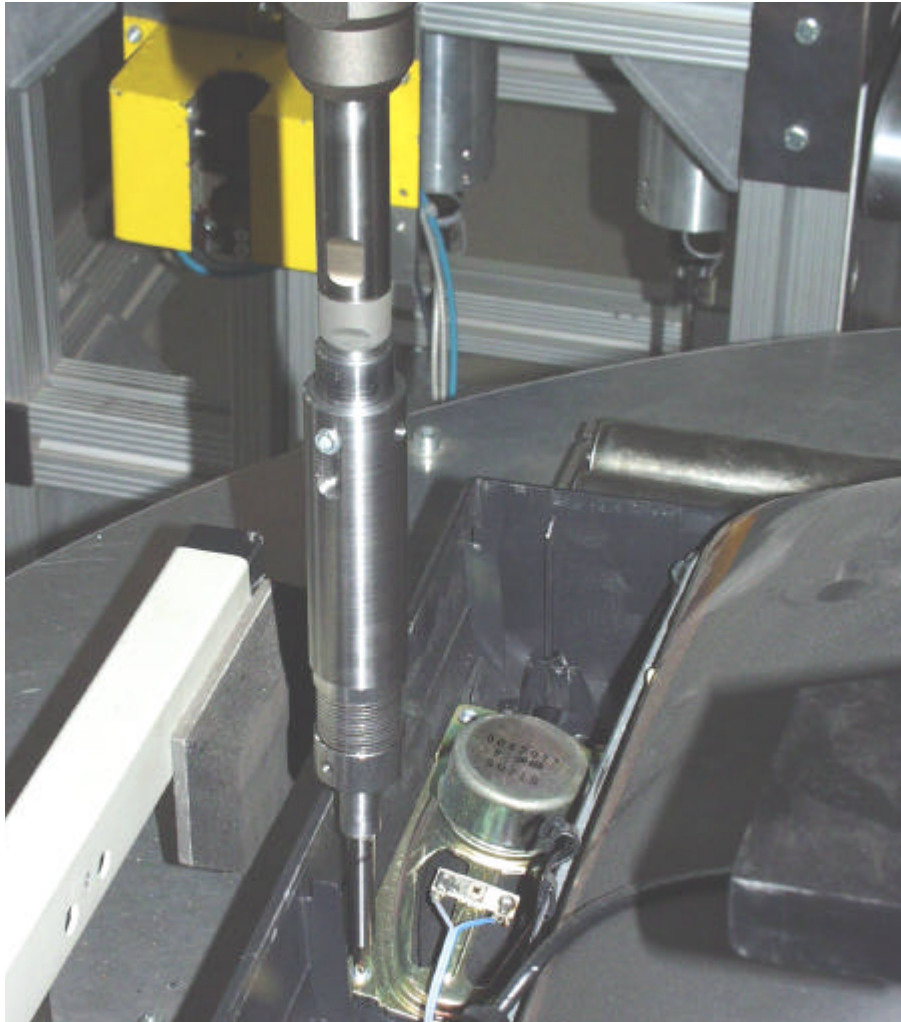
Abb. 5.8: Einsatz des Schraubwerkzeuges mit Ausgleichsmodul in der Bildschirmgerätedemontage
