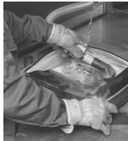
Absaugung der schadstoffhaltigen Bildröhren-Leuchtschicht
