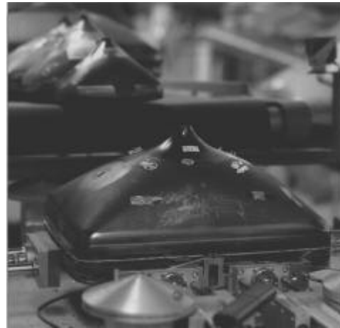
Trockenmechanisch-termische Trennung der Bildröhrenglasteile mittels Heizdraht
