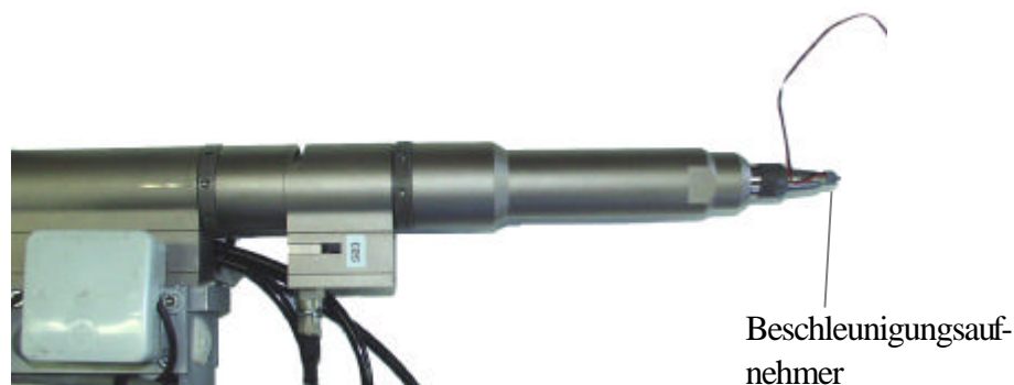
Abb. 4.28: Messung des Druckimpulses mit einem Beschleunigungsaufnehmer
