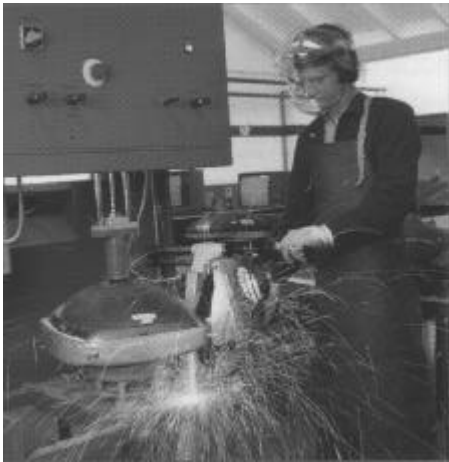
Abtrennung des Implosionsschutzrahmens
