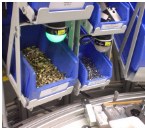
Abb. 1 Anordnung der Lichtsignale
