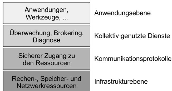
Abbildung 5.2: Schichten einer Grid Middleware, Quelle: [FK03]
