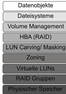
Abbildung 3.4: Schichtenmodell bei der Speicher-Virtualisierung
