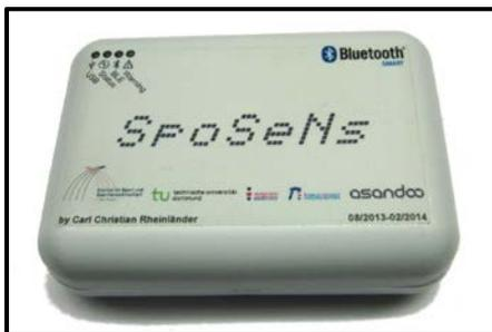
Abbildung 28: Gehäuse des Sensorknotens inklusive Platine und Akku.
