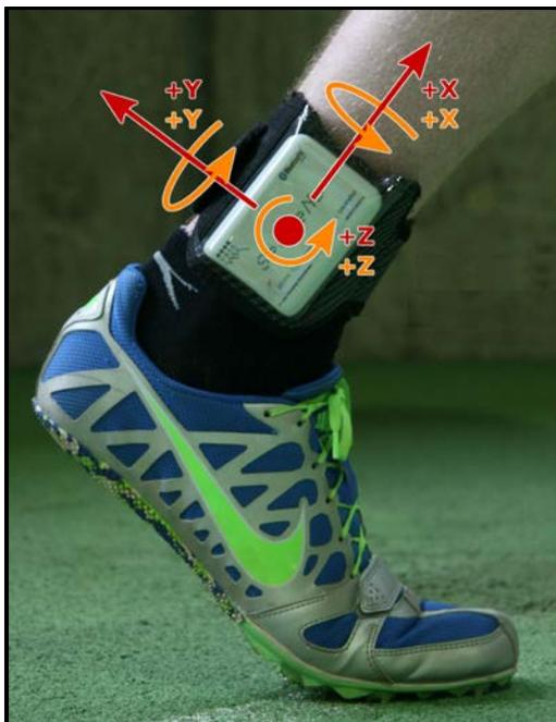
Abbildung 31: Achsausrichtung des Sensors bei Befestigung am Knöchel.
