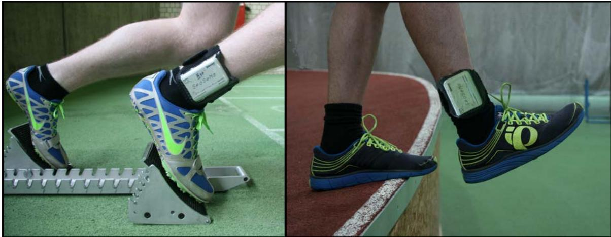
Abbildung 30: Sensorknoten am Knöchel des Sportlers bei Sprints (links) und Dropjumps (rechts).
