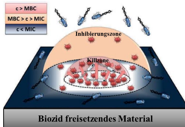
Abbildung 7: Schema der Oberflächenfreisetzung eines mit Biozid beladenen Materials, nach Krumm et. al. 158 .
