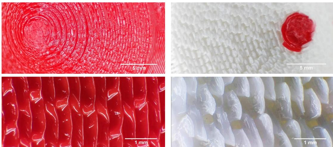
**Abb. A.8:** Probe Nr. 8: Haltekraft 347,5 N, Oberflächenqualität +2
