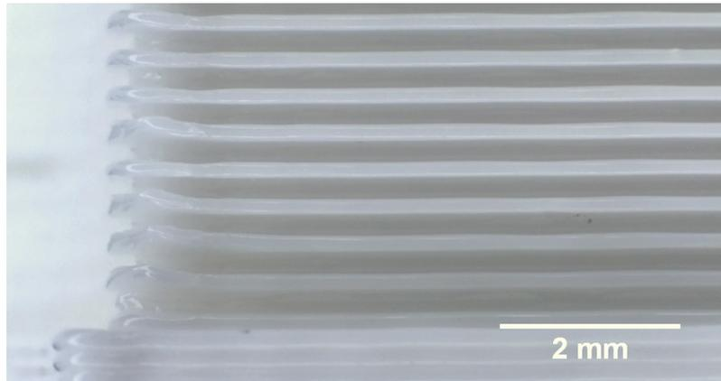
**Abb. 4.77:** Struktur der formschlüssigen Elemente bei der modellgeprägten Verzahnung
