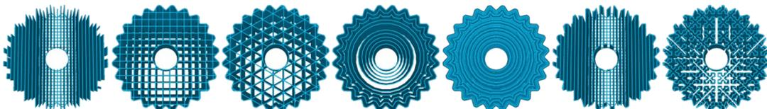
**Abb. 2.18:** Ablegemuster für Stützstrukturen in *Cura 4.6.1* [Ult20a]
