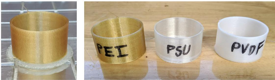
**Abb. 5.4:** Demonstratoren aus den Hochleistungsthermoplasten PEI, PSU und PVDF
