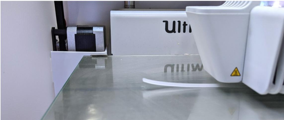
**Abb. 2.29:** Verzug eines Bauteils aus Polypropylene durch Eigenspannungen
