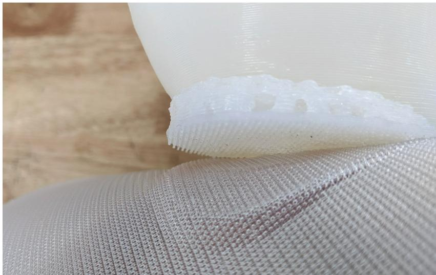
**Abb. 5.3:** Koppelschicht aus *HT5300* zwischen Bauplatte (Glas) und PA
