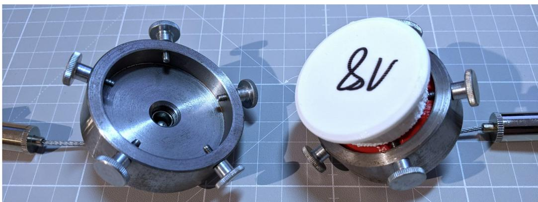
Abb. 4.32: Gefertigte Probenaufnahme mit eingelegter Probe
