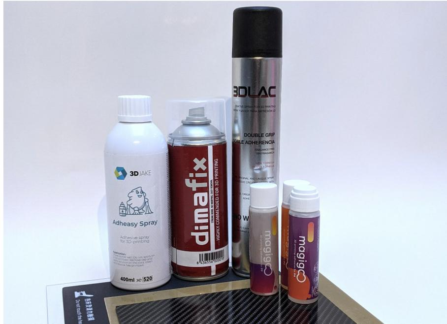
**Abb. 2.5:** Verschiedene Haftvermittler und Bauplatten zur Fixierung des Druckobjektes
