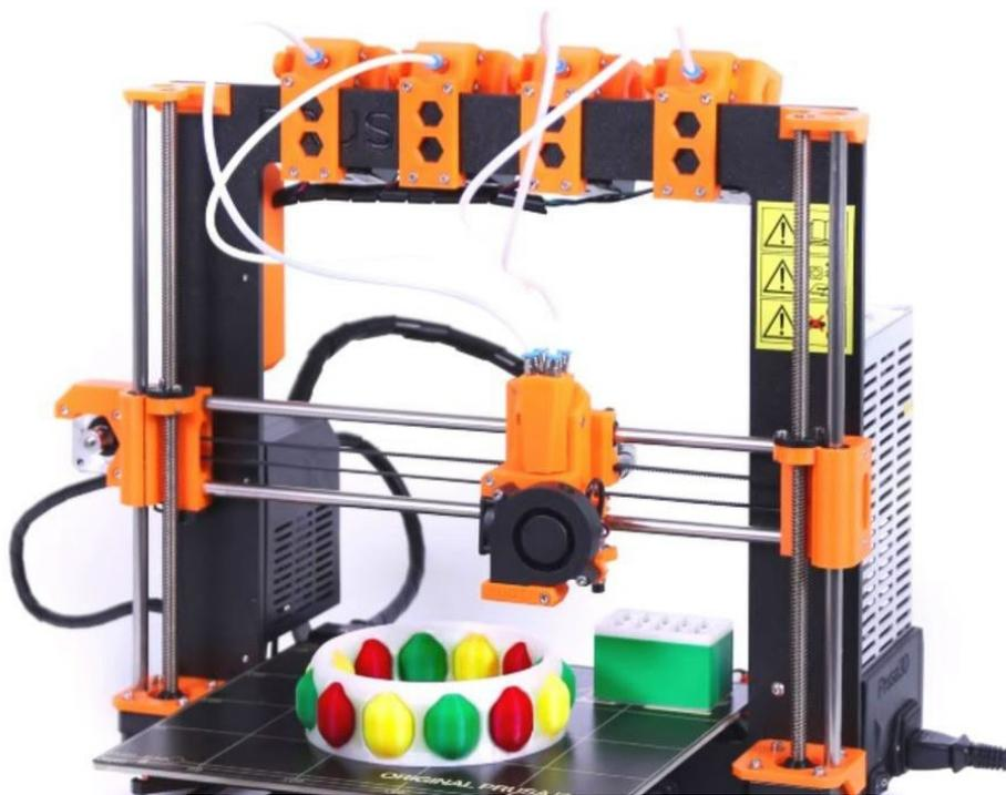
**Abb. 2.12:** *Prusa Multimaterial Upgrade 2.0* für bis zu vier Filamente [Pru20b]
