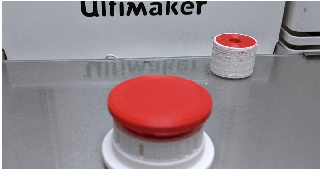
**Abb. 4.36:** Abstreifturm zur Konditionierung der Schmelze beim Düsenwechsel
