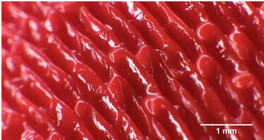
**Abb. 4.45:** Mikroverzahnung bei hoher Haltekraft (Probe 18 oben, VP 30°, 580,3 N)
