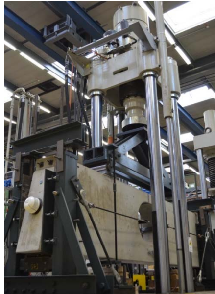
Abbildung 1 Versuchsstand der Ermüdungsversuche aus, Heinrich und Maurer (2019)
