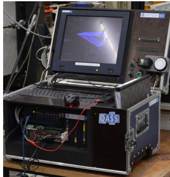
Abbildung 2 QASS-Messgerät zur Körperschallmessung
