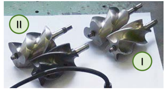
ABBILDUNG 5: Verwendete Rotorpaare: I unbeschichtete Rotoren, II Hauptrotor unbeschichtet, Nebenrotor beschichtet.
