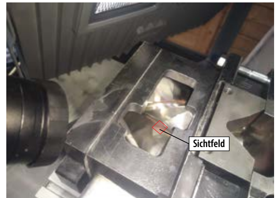
ABBILDUNG 2: Modifiziertes Schraubenmaschinengehäuse und Kameraperspektive
