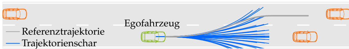
Abbildung 7.1.: Illustration einer beispielhaften Trajektorienschar, welche durch eine konstant gehaltene Stellgröße entsteht. Mithilfe eines Suchverfahrens wird die optimale Stellgröße \mathbf{u}^* aus der Menge \mathbb{U}_S ausgewählt.
